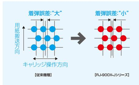
MUTOHのサイン向け大判インクジェットプリンタ「ValueJetシリーズ」で培った横筋(バンディング)を軽減するプリント(エフェクト)技術の移植に加え、キャリッジに走査時の振動を抑えるためのバランサーを組み込み、インク液滴の着弾位置のブレを抑えることにより建築パース図面や3D CAD図面、写真画像、イラスト、塗り潰しなどのグラフィックス要素を多く含んだ図面の作画品質の向上を図りました。
