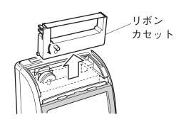
■リボンカセットを取り出します。 図の様に、リボンカセットの前方を手前 に引き起してから、上へはずします。
