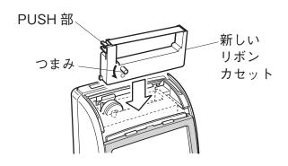
■新しいリボンカセットをセットします。 上から差し込み、前方へ倒してください。 このとき、つまみを反時計方向に回して、 リボンのたるみを直してください。 パチッと音がするまで PUSH 部を強く押 します。
