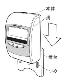
■置台のつめを本体裏面の溝に合わせて、 本体をスライドさせ取り付けます。
