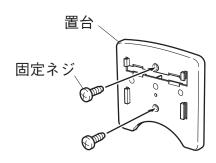
■置台を付属の固定ネジ(壁取付用)で壁にしっかりと固定します。
